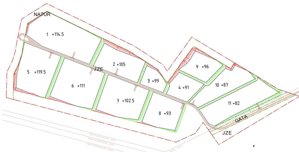
Figur 3. Skärmlapp från höjduredning för terrassering av område, upprättad av Tyréns Sverige AB 2026-09-08. Grönt visar slänter, rött visar skärning.
